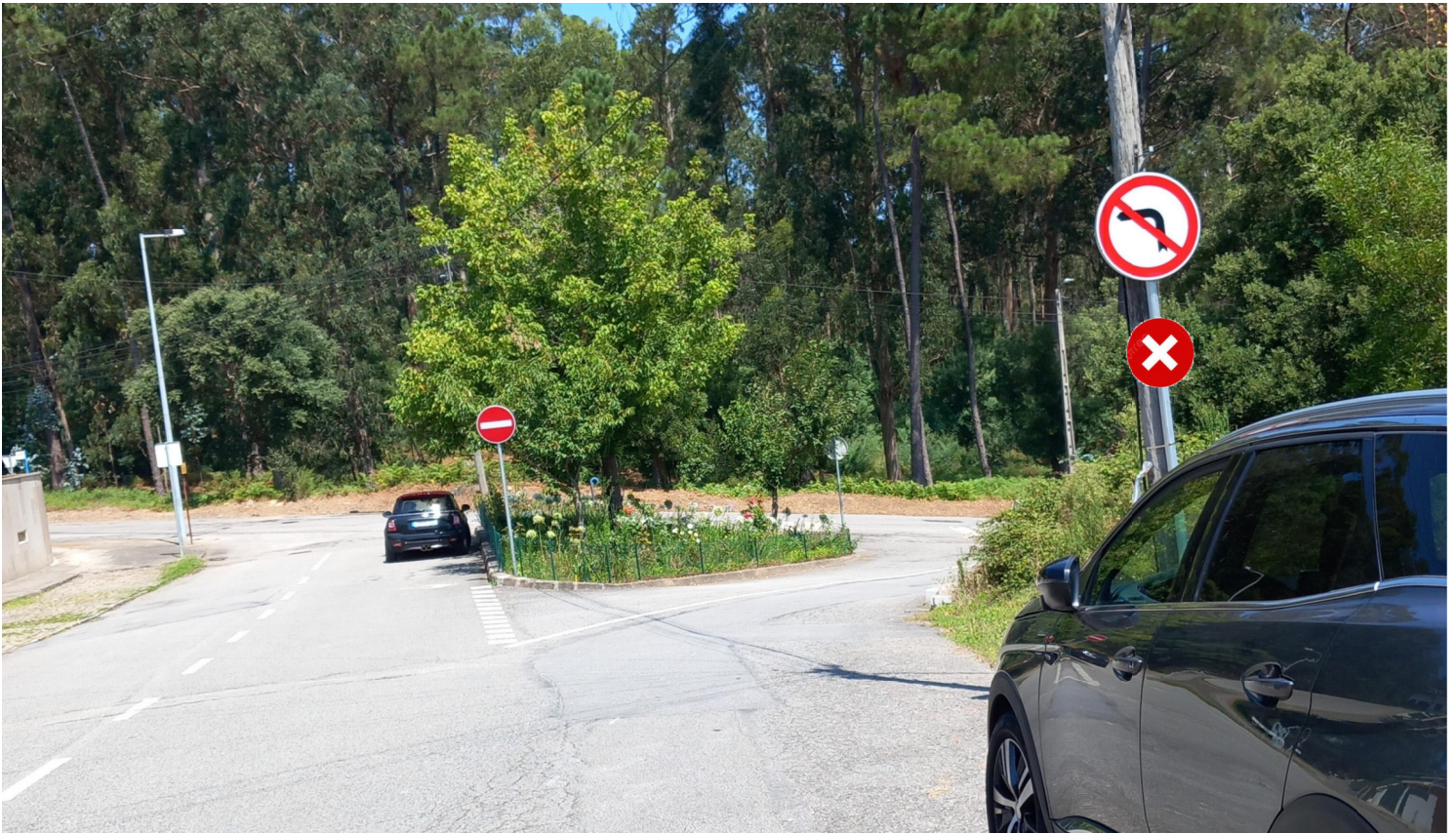
Sinal de trânsito fixo vertical C11b – Proibição de virar à esquerda (a retirar)
