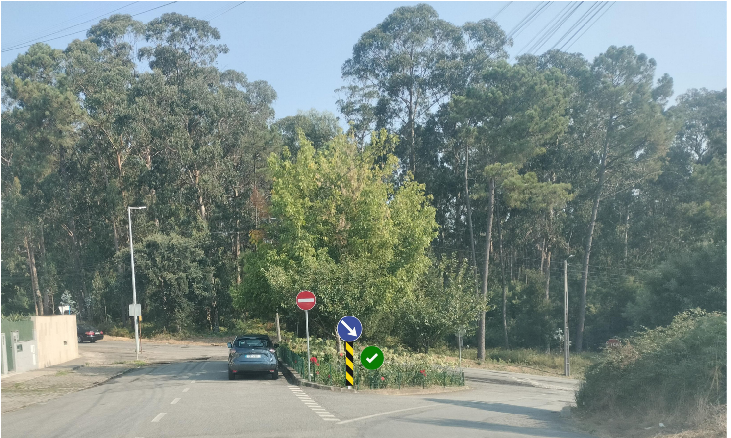
Conjunto de sinalização de trânsito fixa vertical D3a – Obrigação de contornar a placa ou obstáculo + O7a – Baliza de posição (a colocar)
