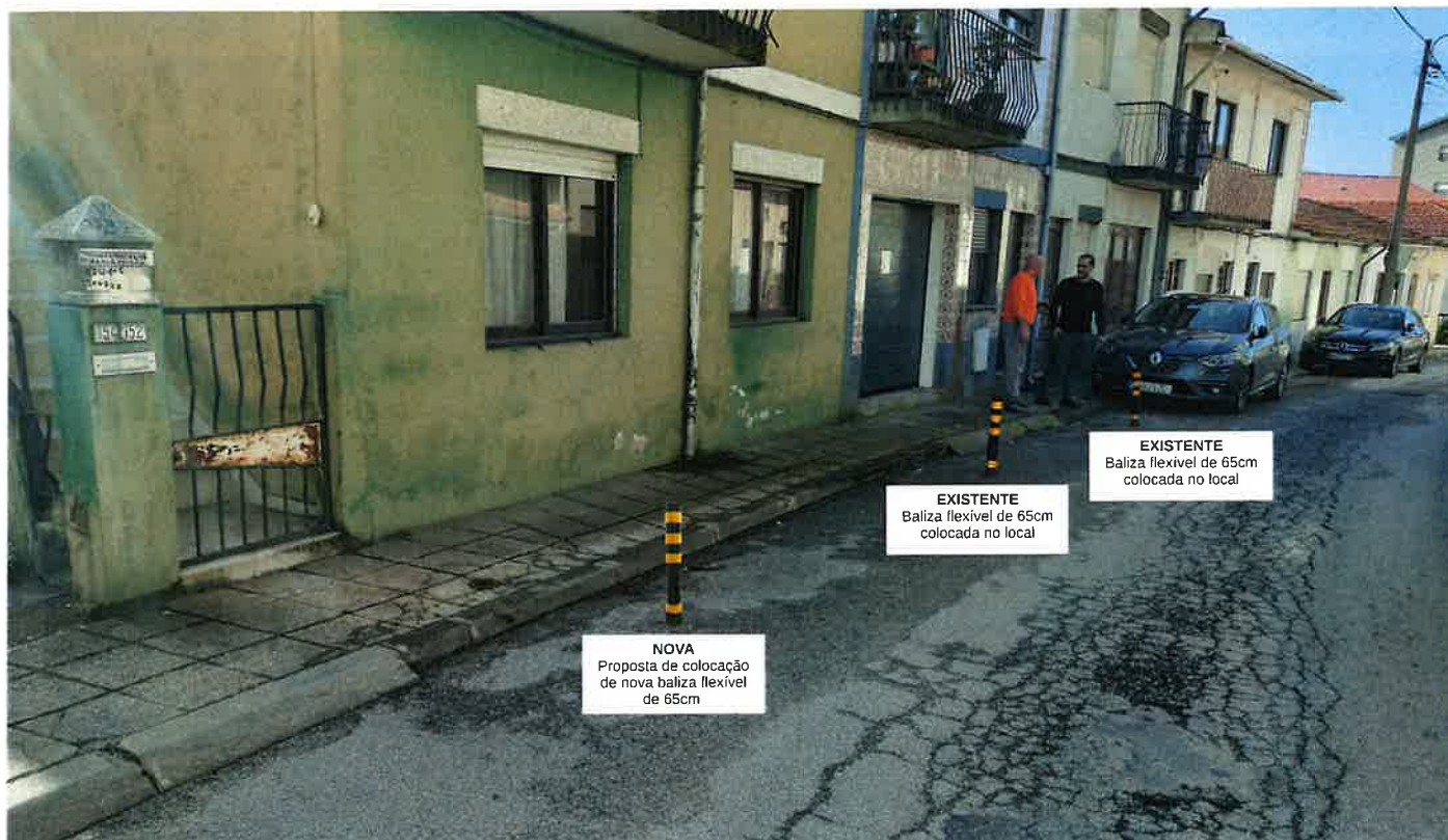
Colocação de baliza flexível de 65cm no alinhamento das existentes Vista no sentido descendente
